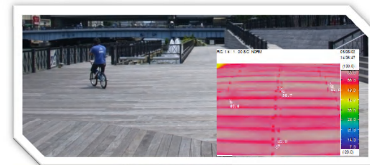
上の写真は湊町リバープレイスのウッドデッキとその熱画像。表面温度は60℃を超えている(2006/8/2午後2時)
